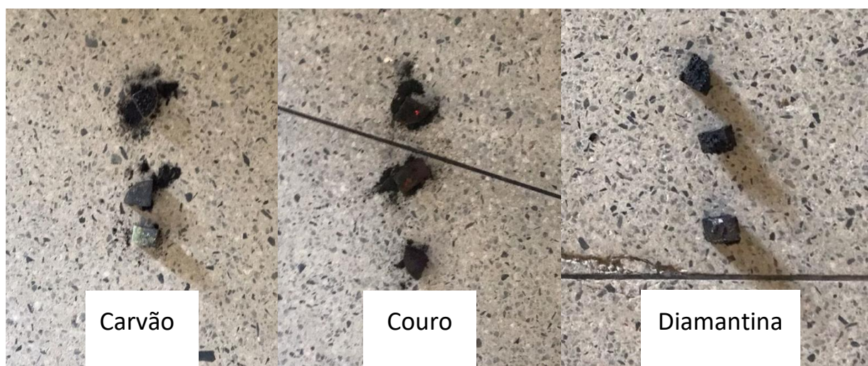
Figura 2: Corpos de prova do metal 1 - aço 1043 - após a cementação
