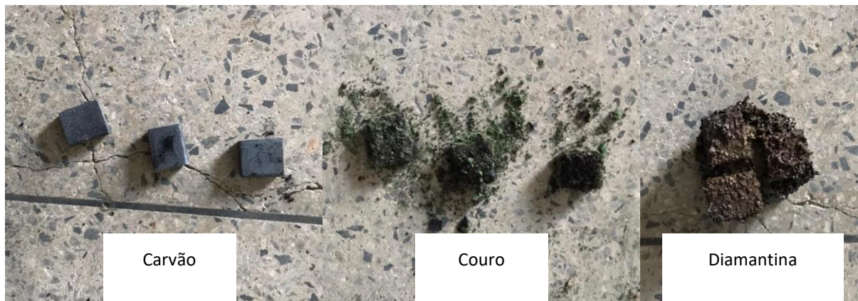
Figura 3: Corpos de prova do metal 2 - aço 1020 - após a cementação
