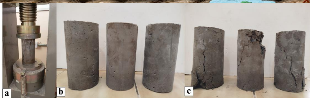
Figura 4 - Padrão geral de rompimento dos traços pela máquina de prensa eletro-hidráulica I-3025-B ( Fig. 1a. ); Caso particular do traço T 1 de 07 dias: Fig. 1b | Fig. 1c antes | após o rompimento. Fonte: Arquivo Pessoal (2024).
