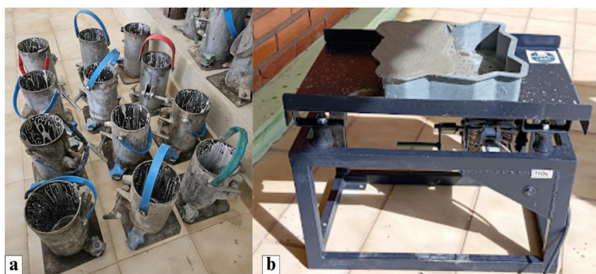
Figura 2 - Materiais Fig. 1a. Forma para corpo de prova cilíndrico 10x20 cm com desmoldante siliconado de lote 32-09; Fig. 1b. Forma piso bloquete duplo 16 faces 24x10x8 cm e mesa vibratória de porte pequeno. Fonte: Arquivo Pessoal (2024).
