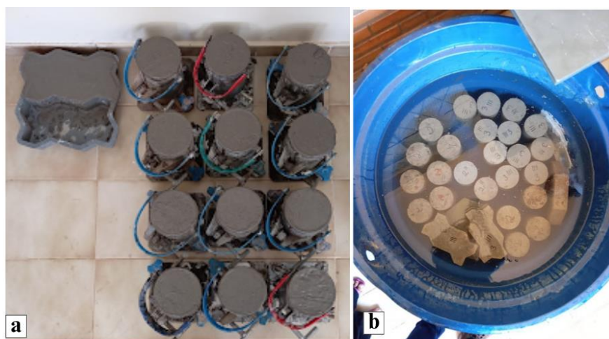
Figura 3 - Etapas Fig. 1a. Preparação dos corpos de prova nas formas cilíndricas 10x20 cm e no bloquete duplo 16 faces 24x10x8 cm; Fig. 1b. Reservatório para cura de 7 a 28 dias dos traços T_1 , T_2 e T_3 . Fonte: Arquivo Pessoal (2024).
