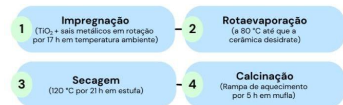
Figura 1. Fluxo descritivo da síntese dos óxidos metálicos.
