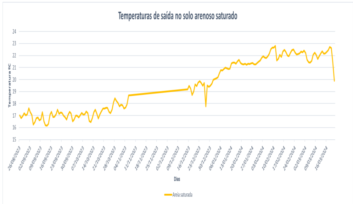
Figura 5: Temperatura do ar na saída do duto em solo arenoso saturado na simulação numérica no Ansys Fluent.
