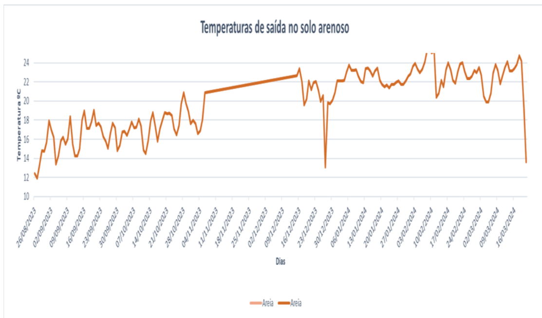
Figura 4: Temperatura do ar na saída do duto em solo arenoso na simulação numérica no Ansys Fluent.
