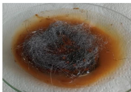
Figura 3: Corrosão da lâ de Ferro em meio neutro. Fonte: acervo pessoal do autor.
