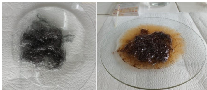
Figura 2: Corrosão da lâ de ferro em pH 2. Fonte: acervo pessoal do autor.
