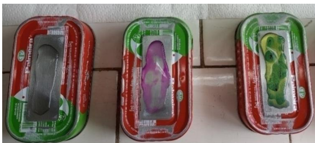
Figura 1: Conjunto de tampas de alimentos para experimentos de corrosão. NaCl 3,5% (esquerda); NaCl 3,5% + fenolftaleína (centro) e NaCl 3,5% + K_3[Fe(CN)_6] (direita). Fonte: acervo pessoal do autor.
