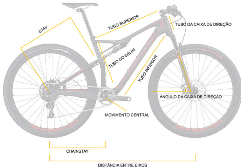
Figura 1: Elementos da geometria do quadro da bicicleta. Fonte: MTB Brasília [4].
