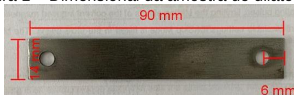
Figura 1 – Dimensional da amostra de dilatométrica
