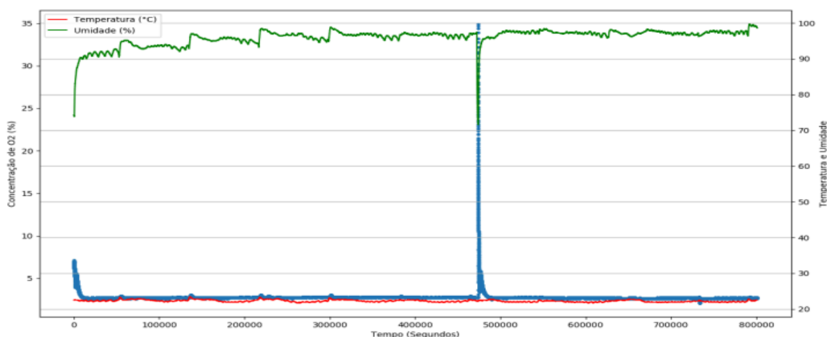
Figura 4: Monitoramento da condição interna da câmara de armazenamento, mostrando a concentração de O_2 , a temperatura e a umidade relativa.
