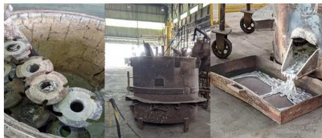
Figura 4. Peças para refusão, dispositivo de refusão e metal refundido retirado das peças
