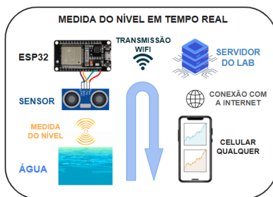
FIGURA 2. Esquema de montagem do medidor e transmissão dos dados.
