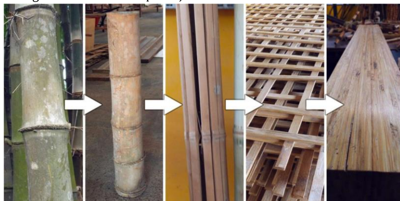
Figura 5 – Processo de produção do BaLC na Universidade de Brasília
