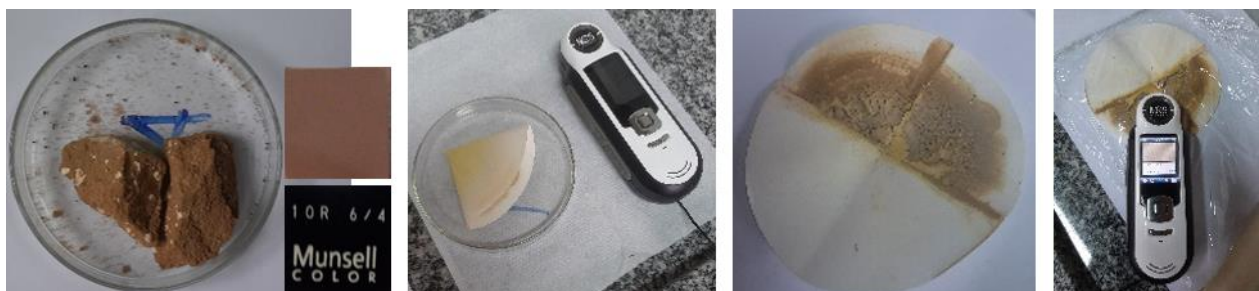
Figura 20: (da esquerda para a direita) – Torrões da amostra A 4 analisados pelo processo MUNSELL obtendo a cor 10R 6/4 . Papel de filtro com os finos (argila e ou silte) e colorímetro digital RM200 NCS (Natural Color System). Papel de filtro com resíduo dos finos, amostra A 4 . Aferição da cor dos finos pelo processo NCS identificando a cor dos finos como S4010-Y10R . Fonte: Grupo de pesquisa PIBITI, jul. 2023.
