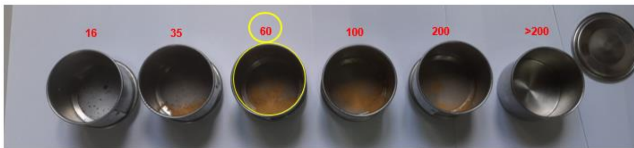
Figura 19: (acima) – Peneiras de malhas 16; 35; 60; 100; 200 e >200. (centro da esquerda para a direita) - Peneira malha 35. Colocação dos grossos do béquer para a agitação manual por 5 minutos. Pesagem peneira 60 + material retido. Peneira 60 com material retido (o de maior peso retido). (abaixo) – Peneiras de malhas 16; 35; 60; 100; 200 e >200 após agitação manual com material retido (em amarelo a malha que mais reteve material - areias médias). Fonte: Grupo de pesquisa PIBITI, jul. 2023.
