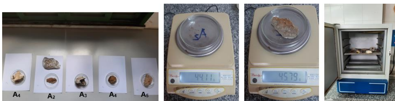
Figura 14: (esquerda) - Preparação das amostras para observação visual e análise de umidade. (centro) – Pesagem da amostra A 2 . (direita) – Amostras A 1 , A 2 , A 3 , A 4 e A 5 colocadas na estufa para secagem. Fonte: Grupo de pesquisa PIBITI, jun. 2023.
