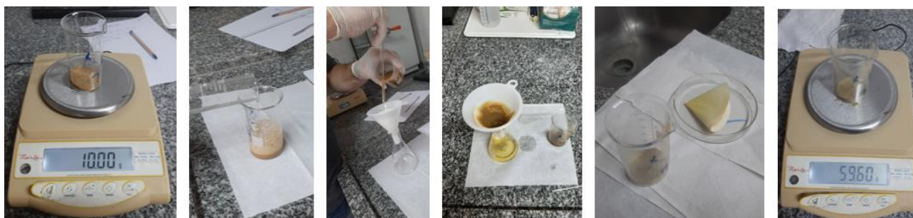
Figura 18: (da esquerda para direita) – Pesagem da Amostra A 4 após ser destorroada para ensaio do traço. Ataque com ácido clorídrico para separação dos grossos dos finos (digestão). Filtragem da Amostra A 4 após ataque ácido. Resultado da separação dos grossos dos finos da amostra A 4 . Grossos (béquer) e finos (papel de filtro) após secagem na estufa por 24 horas da amostra A 4 . Resultado da pesagem dos grossos da amostra A 4 . Fonte: Grupo de pesquisa PIBITI, jul. 2023.
