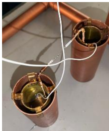
Figura 3 – Recipientes coletores no interior do tubo.
