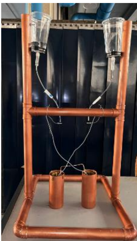
Figura 5 – Gerador eletrostático chuva elétrica de Kelvin.
