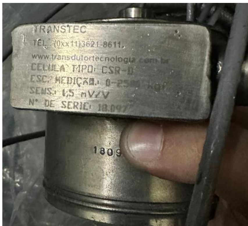
Figura 2: Célula de carga responsável pela medição de tensão da chapa
