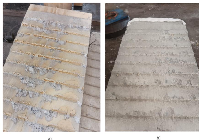
Figura 12: Modos de falha em corpo de prova do grupo B no CLT (a) e no concreto (b)
