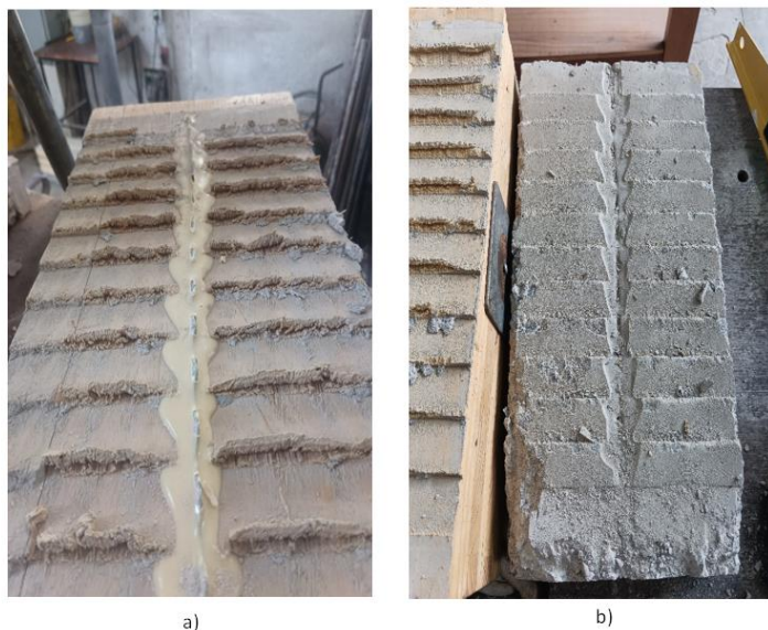
Figura 11: Modos de falha em corpo de prova do grupo A no CLT (a) e no concreto (b)
