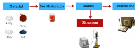
Figura 1. Procedimento experimental da síntese de reação do estado sólido assistido por ultrassom.
