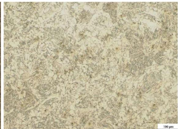
Contorno de grão separados por cementita e ferrita. Há grãos de ferrita contornando regiões de martensita
