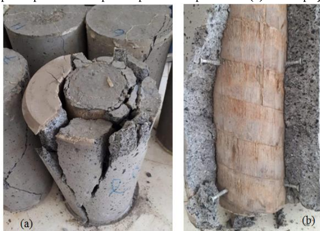
Figura 9 – Visualização pós ruptura dos corpos de prova sem parafusos (a) e no espaçamento de 12,5 cm (b).
