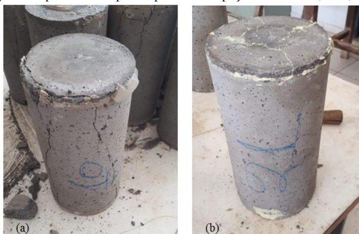
Figura 10 – Comparação da ruptura dos corpos de prova nos espaçamentos de 12,5 e 3,125 cm, respectivamente
