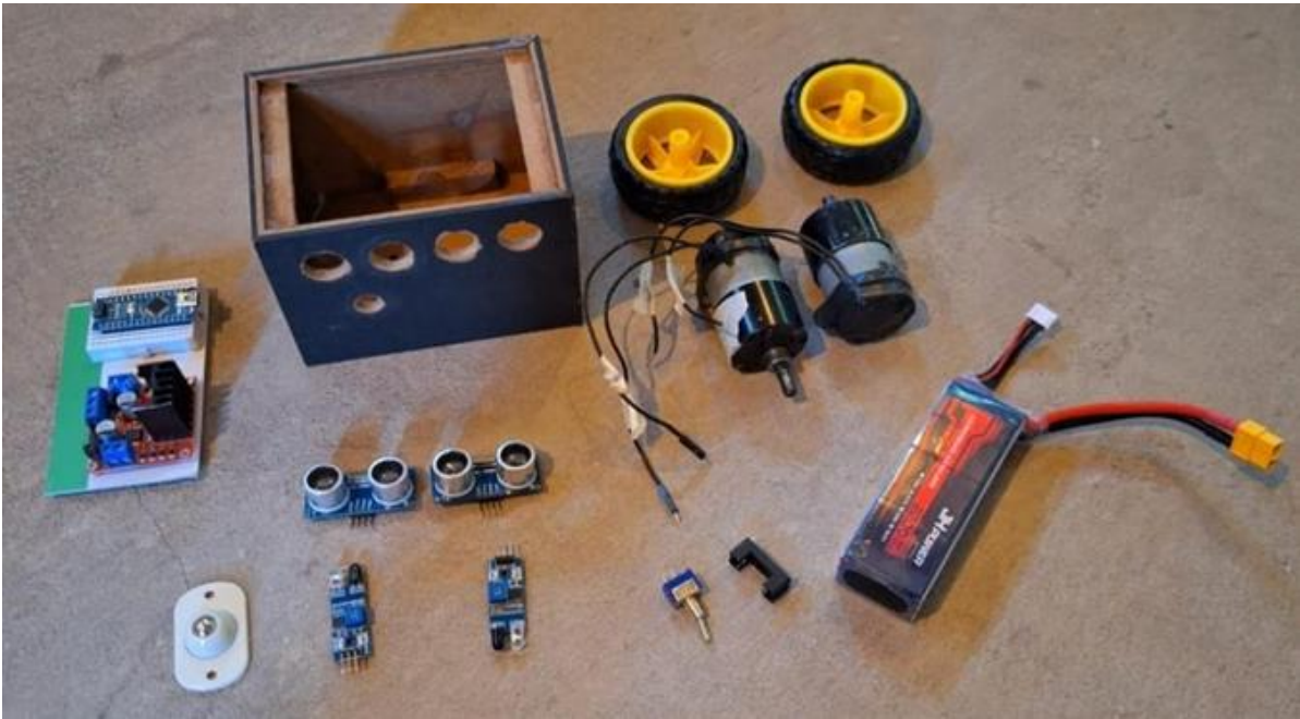
Figura 8 - Componentes Utilizados para a Montagem do Robô
