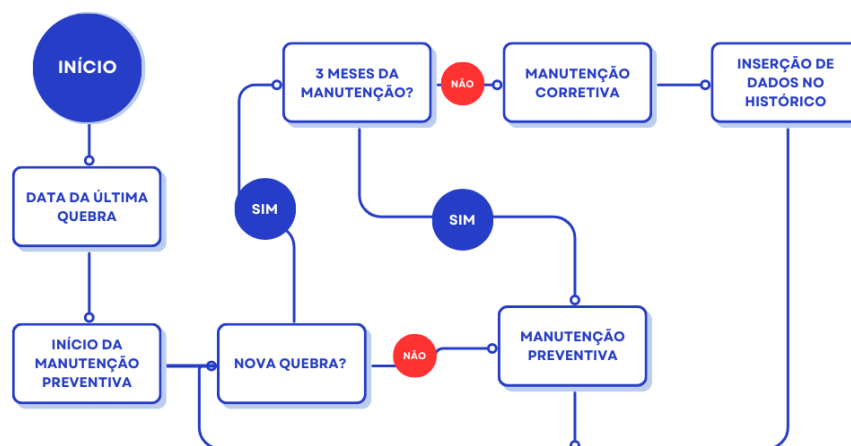
Figura 1: Fluxograma do funcionamento do processo de implementação das práticas do PCM a partir da manutenção corretiva.
