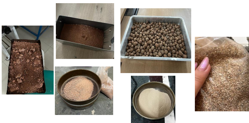
Figura 1 Argila seca para trituração; argila triturada em moinho britador; argila expandida na forma habitual e argila triturada e passada na peneira; vermiculita expandida.
