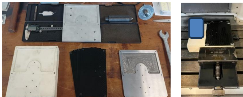
Figura 6 - Figura da esquerda: placa à esquerda inferior feita de resina PU, ao centro placa feita em alumínio e à direita placa feita em aço. Figura à direita: Dispositivo fixado no centro de usinagem com o sensor de frequência acústica.
