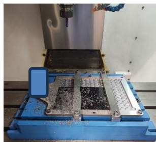
Figura 8 - Dispositivo projetado e construído para acomodar placas de carbono e sensor de frequência acústica.
