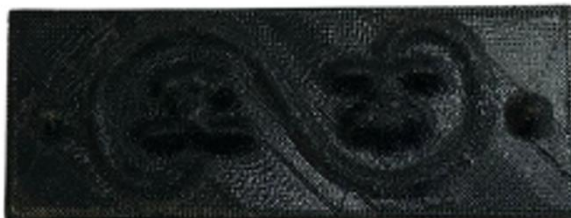
Figura 1 – Carimbo com detalhe do manto mouro, fabricado na impressora 3D.
