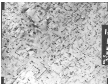
FIGURA 1: Imagem do precipitado na fase \beta'' na liga Al-Mg-Si 6063.
