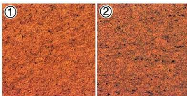
FIGURA 7: MO da amostra 3 envelhecida a 160°C. 1: Seção Longitudinal, 2: Seção transversal. ampliação 200x com escala de 100µm.
