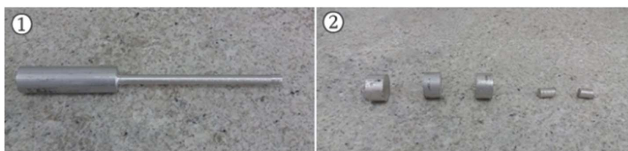
FIGURA 2: 1. Material recebido para estudo; 2. Cortes do material para obtenção das amostras.
