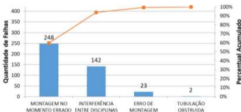
FIGURA 2. Diagrama de Pareto das falhas nos processos de montagem das tubulações.
