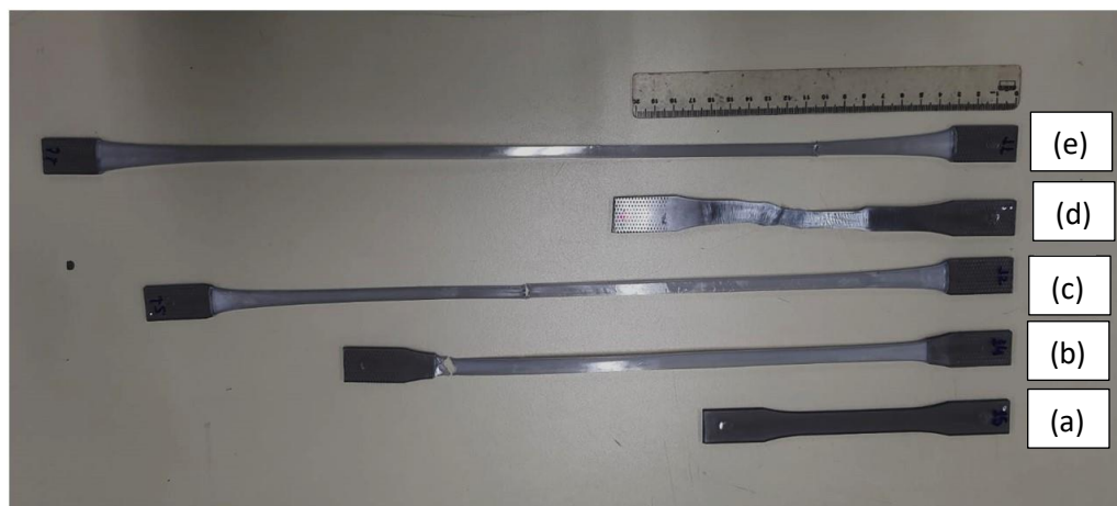
Figura 2. Aspecto visual dos corpos de prova do PET reciclado antes e após o ensaio de tração com e sem os fluidos. (a) PET reciclado antes do ensaio de tração; (b) PET reciclado após ensaio de tração exposto ao óleo de soja; (c) PET reciclado após ensaio de tração exposto ao detergente; (d) PET reciclado após ensaio de tração exposto ao álcool etílico, (e) PET reciclado após ensaio de tração sem fluidos.
