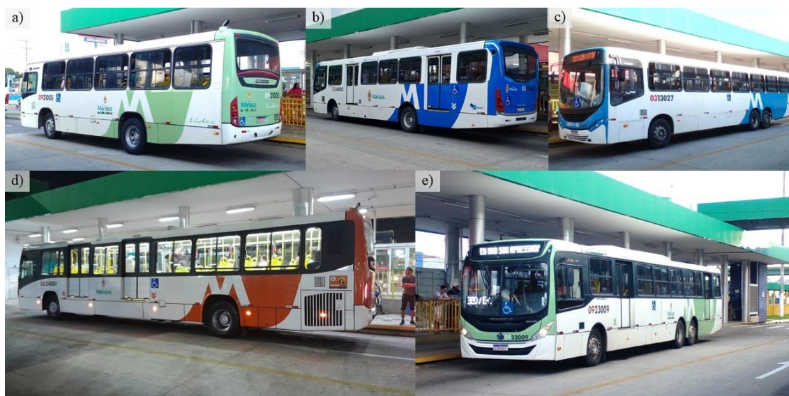
Figura 2. No mosaico: a) “midiônibus” com capacidade de transportar aproximadamente 50 passageiros; b) ônibus convencional com capacidade de transportar 70 passageiros; c) ônibus seminovo com 15 metros de comprimento; d) ônibus do modelo Mercedes Benz “Super Padron” com 14 metros de comprimento; e) ônibus de motorização dianteira e 15 metros de comprimento. Imagens do autor entre dezembro 2023 e julho de 2024.
