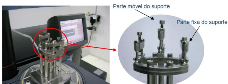
Figura 2. Suporte para amostras do tipo Cantilever para uso em DMA.
