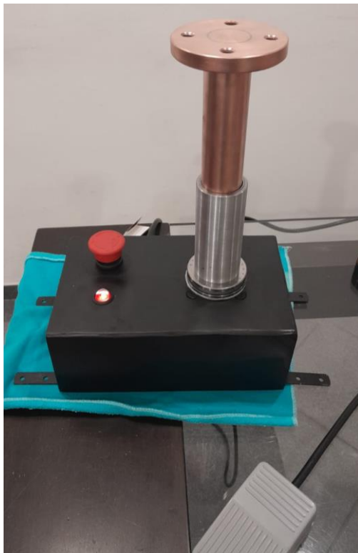
Figura 4 – Dispositivo rotativo para soldas cilíndricas
