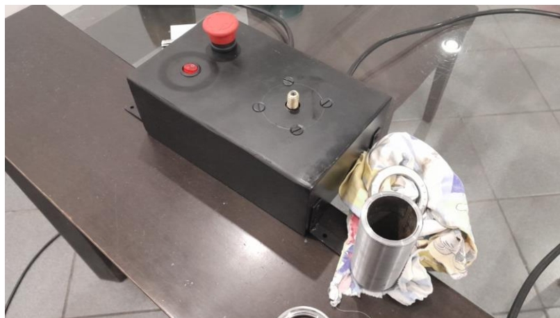
Figura 3 – Montagem do acoplamento de sustentação das peças
