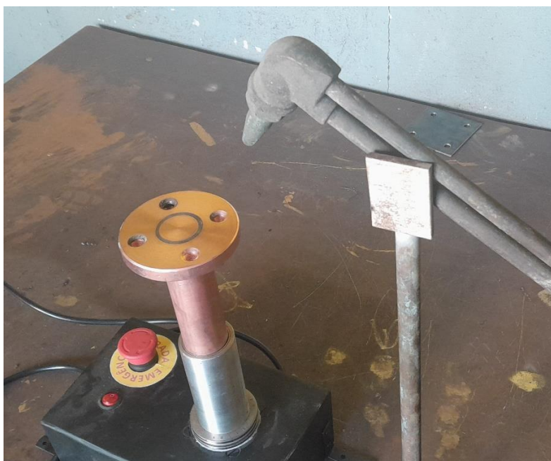
Figura 5 – Apoio para o maçarico
