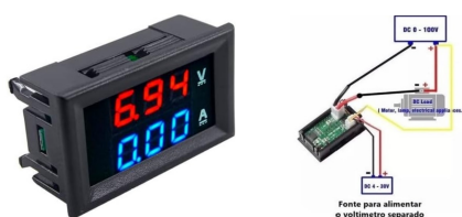
FIGURA 11: Voltímetro/Amperímetro com circuito de ligação
