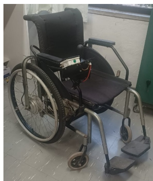
FIGURA 17: Protótipo Implementado da Cadeira Motorizada
