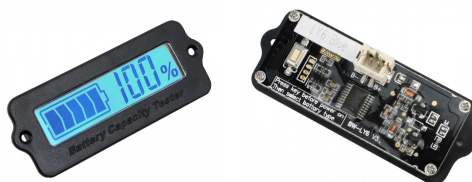
FIGURA 12: Medidor de percentual de carga da bateria
