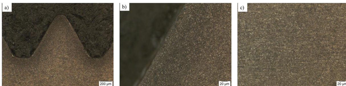
FIGURA 9. Microestrutura parafuso normatizado a) x100, b) 500x flanco e c) x500 núcleo.
