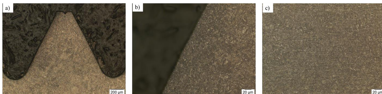
FIGURA 8. Microestrutura parafuso genérico a) x100, b) 500x flanco e c) x500 núcleo.
