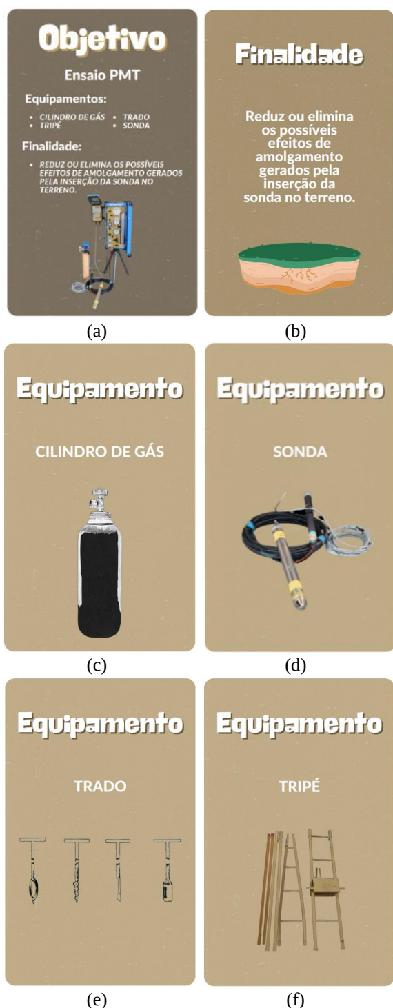
Figura 1. Modelo das cartas para ilustrar o Ensaio Pressiométrico (PMT) (a) Carta de Objetivo, (b) Carta de Finalidade, Cartas de Equipamento como (c) cilindro de gás, (d) sonda, (e) trado e (f) tripé. Fonte: Autoria Própria (2024)
