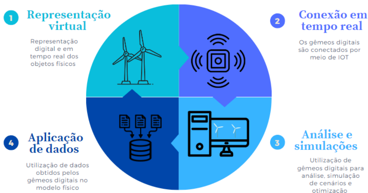
FIGURA 3 - Esquema de representação dos ciclos de um gêmeo digital com a utilização de IoT, destacando a interação contínua entre o mundo físico e digital para otimização e monitoramento em tempo real.
