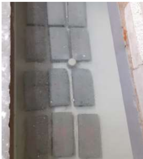
Figura 13 – Pavers no tanque de imersão
