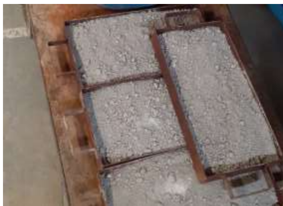
Figura 8 – Lodo de marmoraria seco
