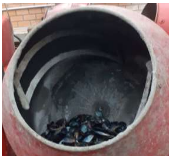
Figura 1 - Lavagem das conchas em betoneira
