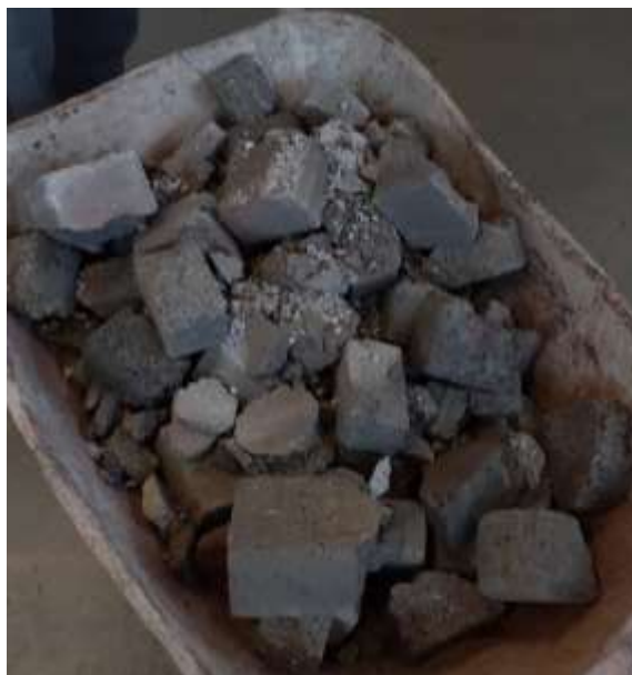
Figura 14 – Corpos de prova rompidos
