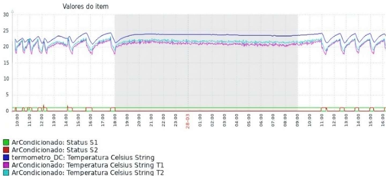
FIGURA 9. Gráfico com temperaturas internas do Datacenter e de status dos aparelhos de ar condicionado no período de predominância do ar condicionado de menor potência.
