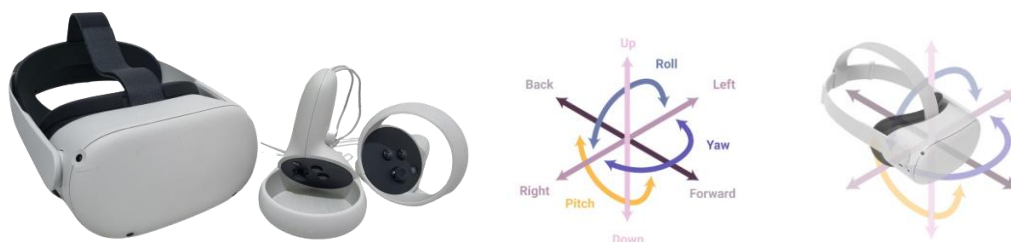
Figura 7: Fotomontagem com o HMD utilizado, e gráfico ilustrativo dos 6 graus de liberdade.
