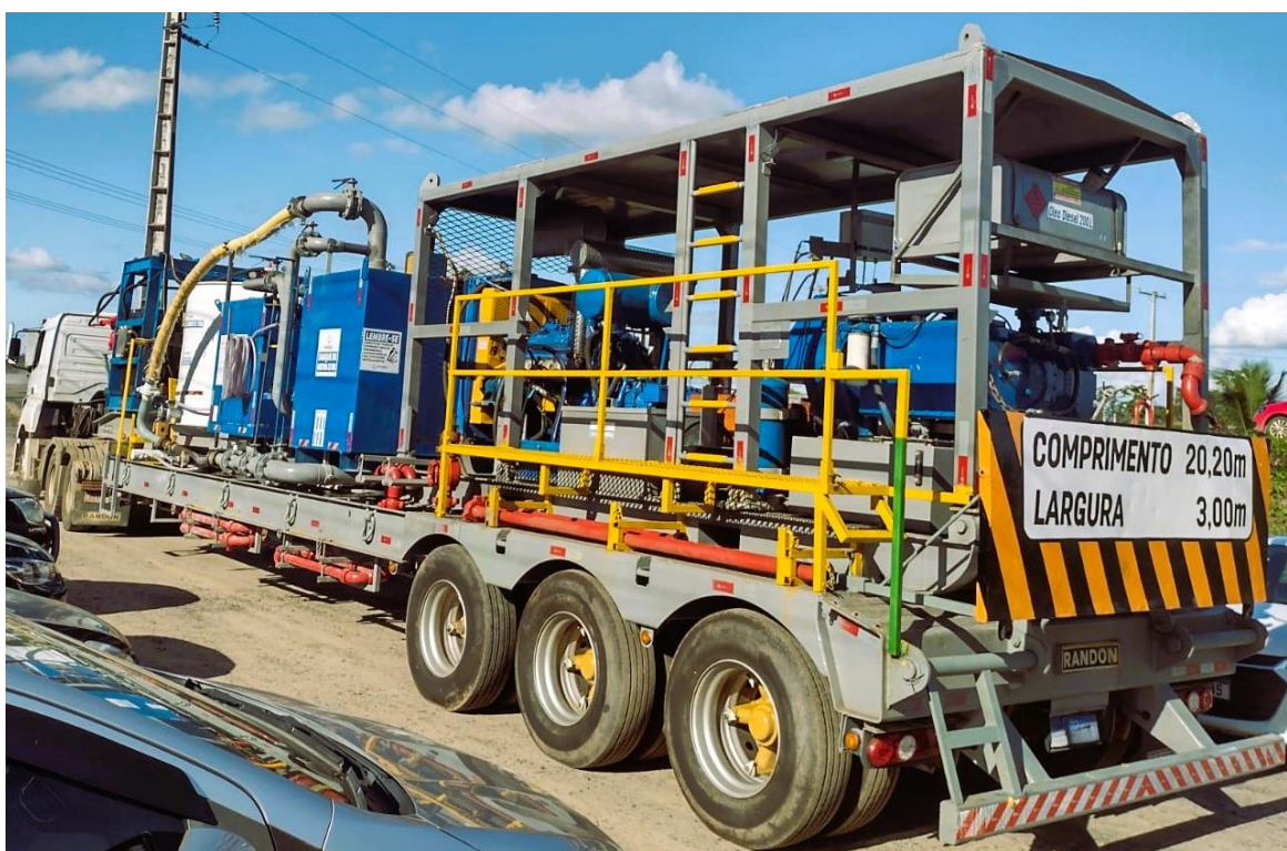
FIGURA 11: Unidade de Cimentação Terrestre finalizada
