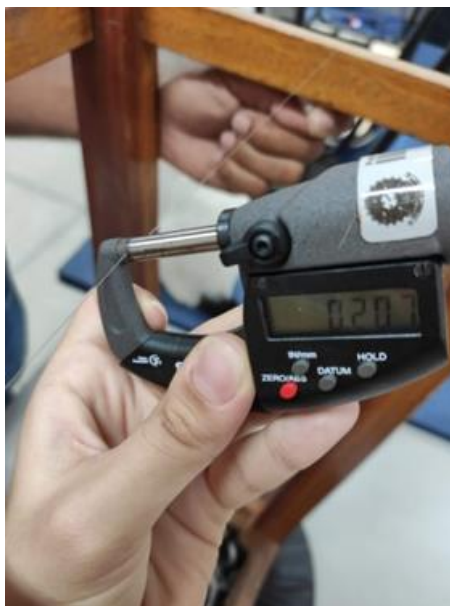
FIGURA 1. Medição do diâmetro das amostras por meio de um micrômetro.
