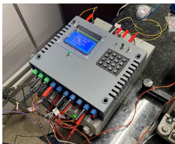
Figura 2: Sistema de controle montado contendo o Arduino Mega alimentado pela fonte de bancada.
