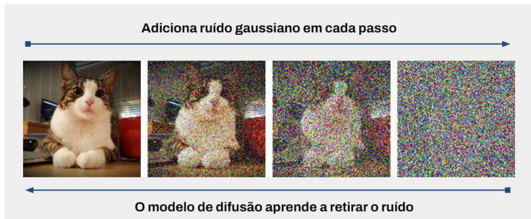
Figura 1: Processo de adição de ruído no treinamento de IAGs
