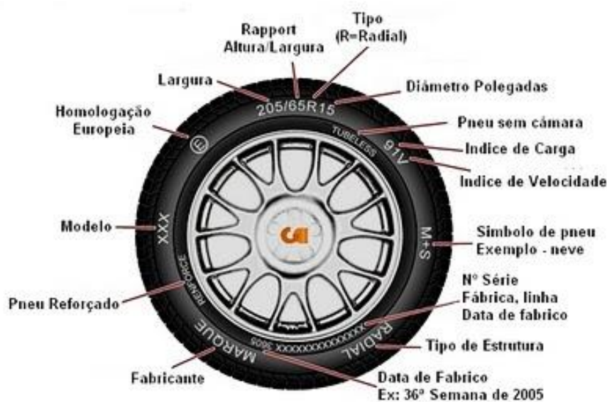
FIGURA 4 - Significado de cada marcação na lateral do Pneu
