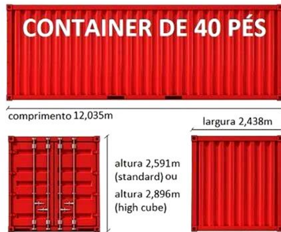
FIGURA 1 – Modelo de contêiner DRY com medidas padrão – 40 pés
