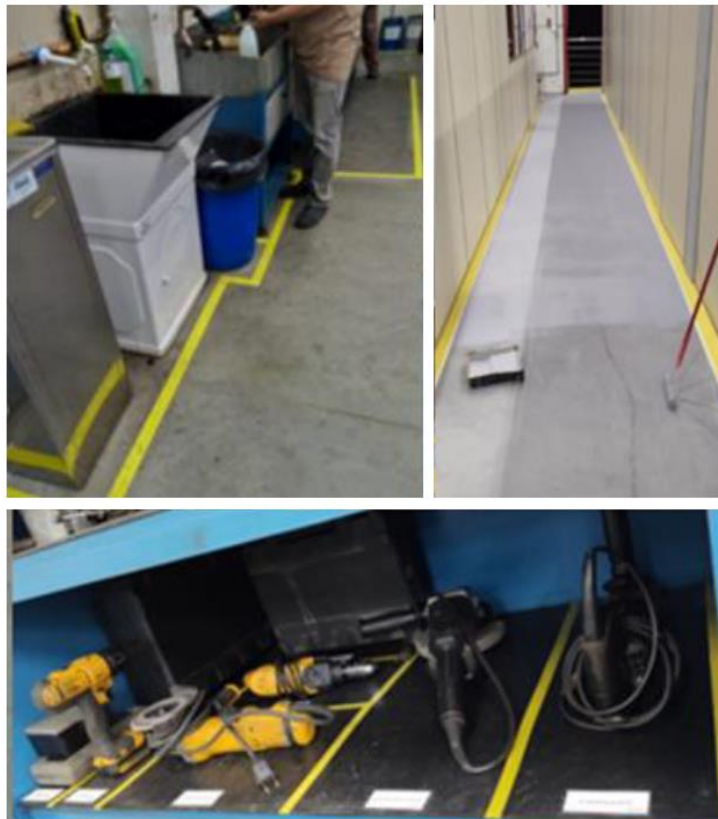
FIGURA 7 – Exemplos de demarcações e padronização da pintura do piso.
