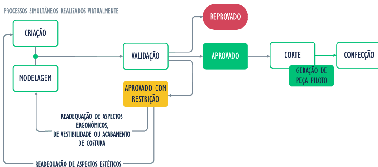
Figura 4: Processo de realização de protótipos virtuais de produtos do vestuário
