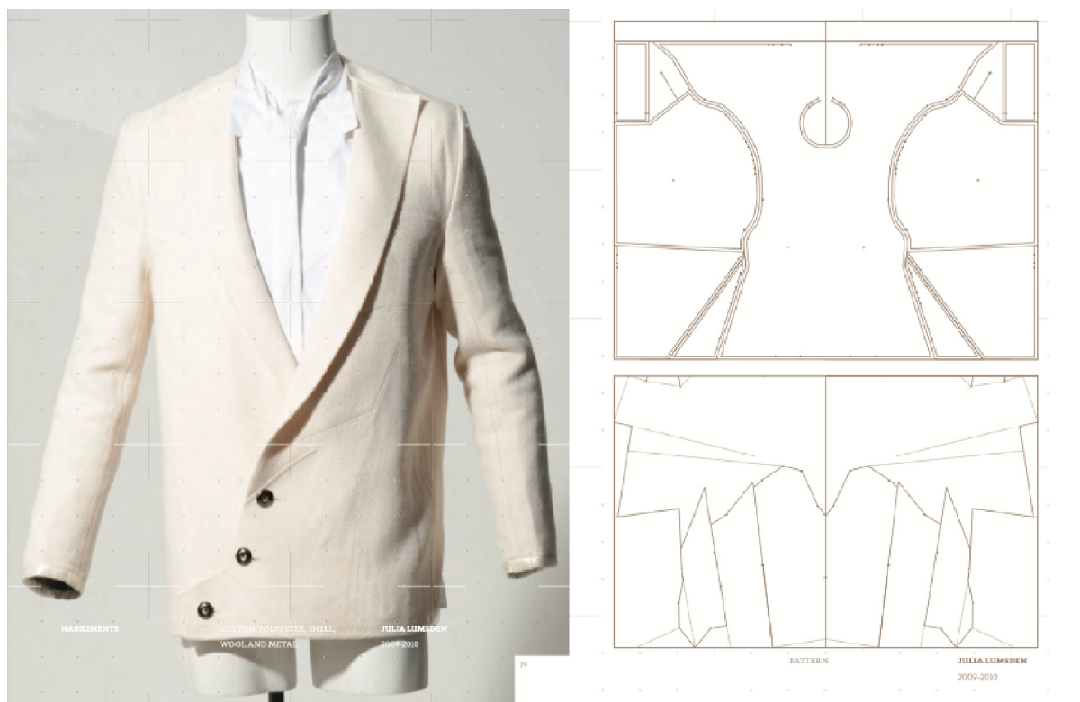
Figura 2: Modelagem zero waste do Blazer
