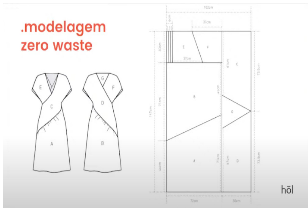
Figura 5: Desenho técnico e plano de corte de vestido zero waste demonstrado na live “Höl.edu | modelagem zero waste para moda 3D”
