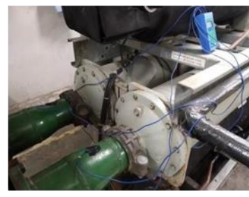
FIGURA 2. Fotos do dispositivo experimental implementado em campo, montagem da instrumentação no chiller .
