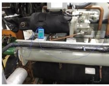
FIGURA 2. Fotos do dispositivo experimental implementado em campo, montagem da instrumentação no chiller .
