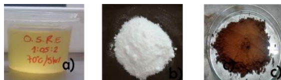
Figura 5. A) Matriz Epóxi B) Anidrido Maleico C) Borra de Café.
