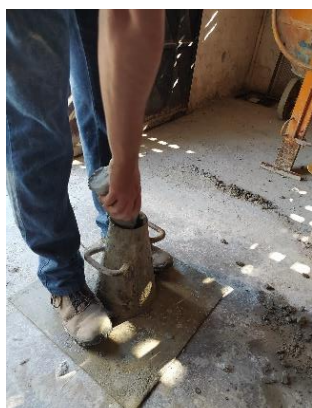
Figura 2. Ensaio de consistência pelo abatimento do tronco de cone (ABNT NBR 16889:2020)
