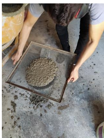
Figura 3. Peneiramento do concreto para ensaio de penetração.
