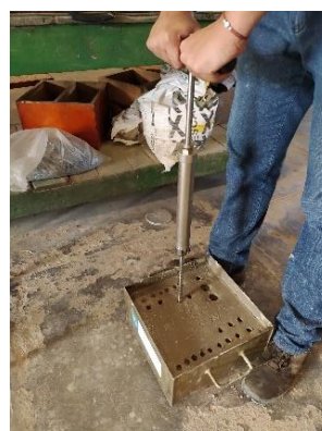
Figura 5. Execução do ensaio de penetração.
