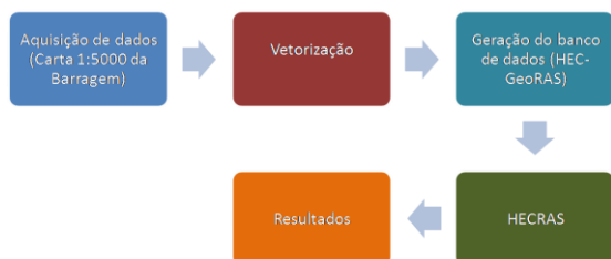
Figura 3- Fluxograma das diversas etapas para a geração do modelo de inundação
