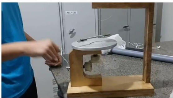
Figura 4: Disco de Arago construído por um grupo de alunos para a Ciência Jovem de 2023. Os materiais foram: 1 disco de alumínio (com eixo para girar), 6 ímãs de neodímio, nylon, madeira, prego e parafuso, manivela e polias cônicas.
