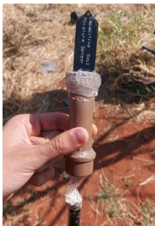
Figura 5. Parte eletrônica do sensor capacitivo isolada. (Autoria própria)
